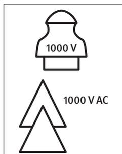
Isolierte Werkzeuge und isolierende Hilfsmittel zum Arbeiten an unter Spannung stehenden Teilen sind geeignet, wenn sie mit dem Symbol des Isolators oder mit einem Doppeldreieck und der zugeordneten Spannungs- oder Spannungsbereichsangabe oder der Klasse gekennzeichnet sind.
